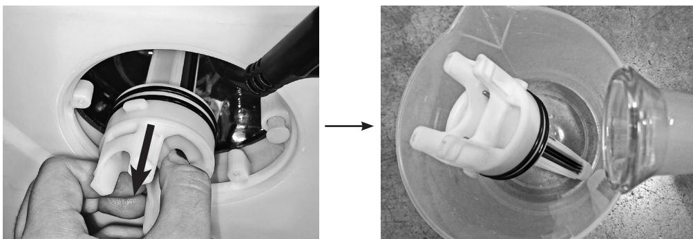
6. Извадете електролитната клетка и измийте титаниевата пластина с прясна вода. Внимавайте: Пазете гнездото на електролитната клетка напълно сухо, не допускайте да влезе в контакт с оцета и водата.
