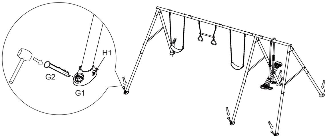
1. Обезопасени основи за закрепване на краката в бетон (не са включени). Нивелирайте комплекта за люлеене и маркирайте местоположението на основата за закрепване на краката. Изкопайте дупки 30 см в диаметър с дълбочина 35 см.
