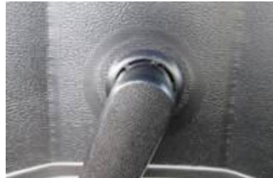
**Стъпка 2:** Проверете дали въздухът може да преминава свободно през клапана и дали гumenото уплътнение не е заклещено или неправилно монтирано. Можете също така да проверите дали вътре в клапана няма замърсявания или запушване.
