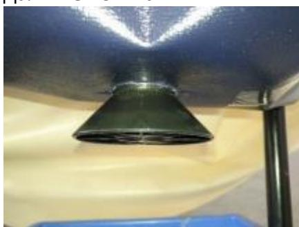
На разположение е нова резервна част, която служи като опора за изпускателния вентил, за да не се претоварва. Тази част може да бъде допълнително доставена към по-старите видове джакузита. Номерът на резервната част е 13342. Новите типове джакузита имат тази опора вече вградена.
