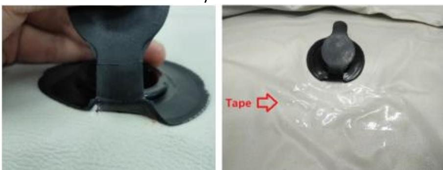
Нанесете лепилото върху мекото PVC в мястото, където изтича вода. Лепилото трябва да бъде нанесено както върху вентила, така и върху дъното на джакузито
